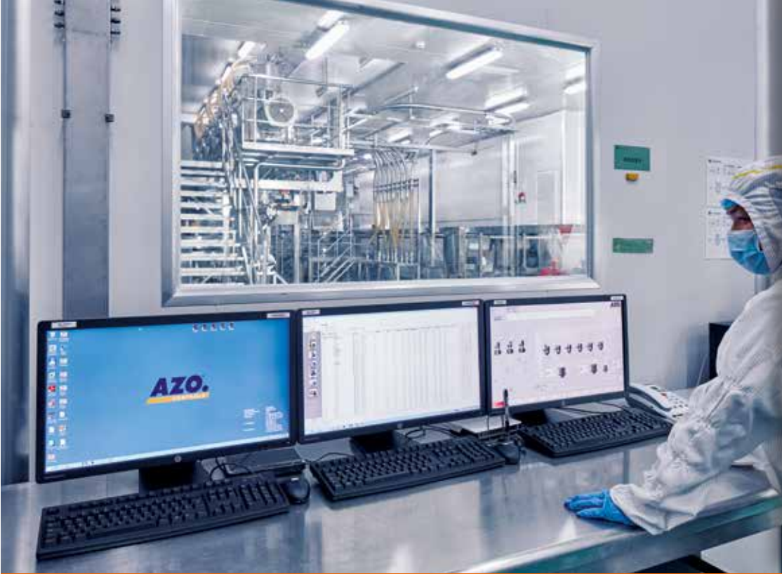
Zentrale Schaltwarte zum Steuern, Bedienen und Überwachen der Anlage und des Prozesses
