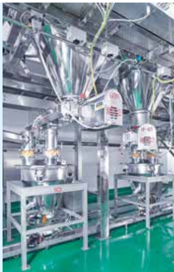
Exakte Wiegung der Kleinmengen in Behälterwaagen
