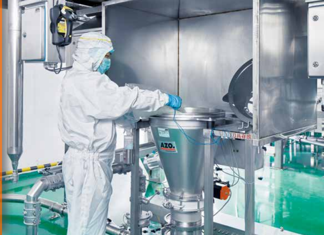
Der Bediener füllt die vorgewogene und etikettierte Charge in den Aufgabetrichter
