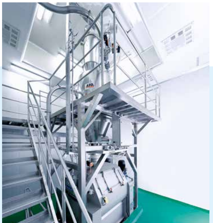
Zuverlässige Beschickung des Mixers über ein Saugwiegesystem
