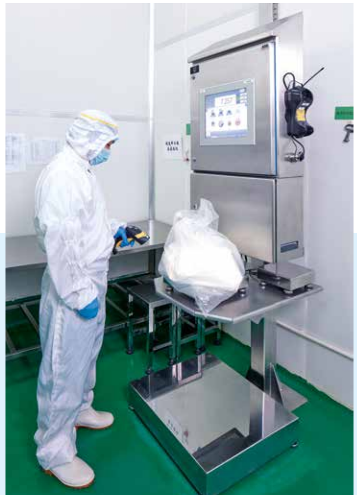
Computer-gestütztes Handeinwaagesystem ManDos zum exakten Wiegen der Kleinstmengen
