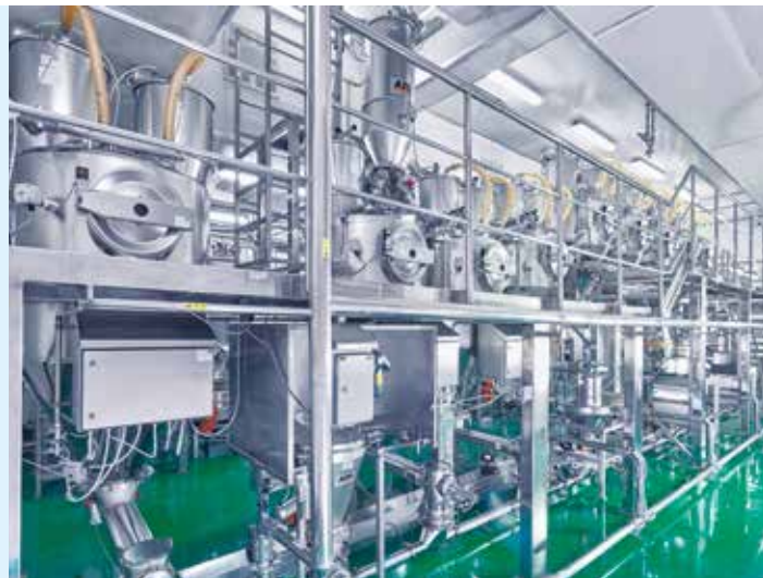
Aus den Pufferbehältern werden die Komponenten in das Saugwiegesystem dosiert
