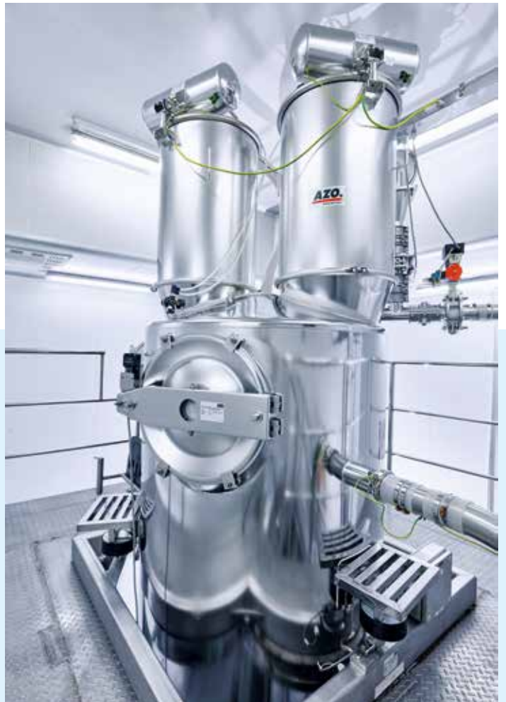
Zuverlässige Beschickung des Mixers über ein Saugwiegesystem mit Förderwaage
