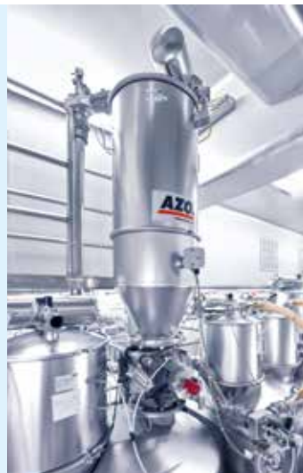
Kontinuierliche Förderung der Großkomponente A in den Pufferbehälter
