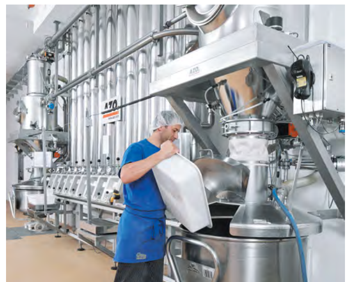
Zugabe der vorgewogenen und dokumentierten Handzutaten in die Knetschale
