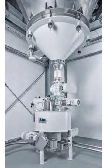
Austragen, Sieben und Verteilen der Mehle. Gute Zugänglichkeit unter den Innensilos
