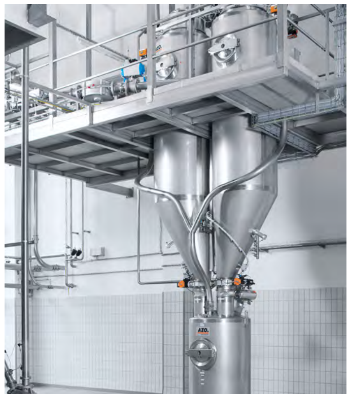
Zwei asymmetrische Abscheider mit Klappen zur diskontinuierlichen Förderung
