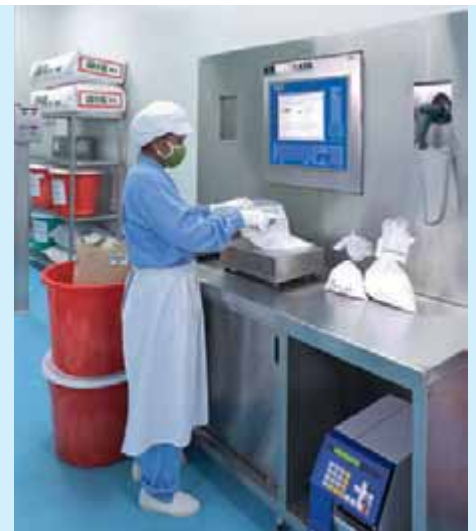
ManDos-Wiegeplatz mit Barcode-Erfassung und Labeldrucker zum Einwiegen von Wirkstoffen
