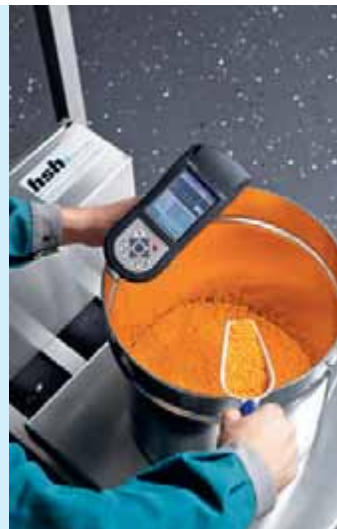
ManDos mobil: Höchste Flexibilität durch fahrbare Waage und mobiles Terminal mit WLAN-Anbindung
