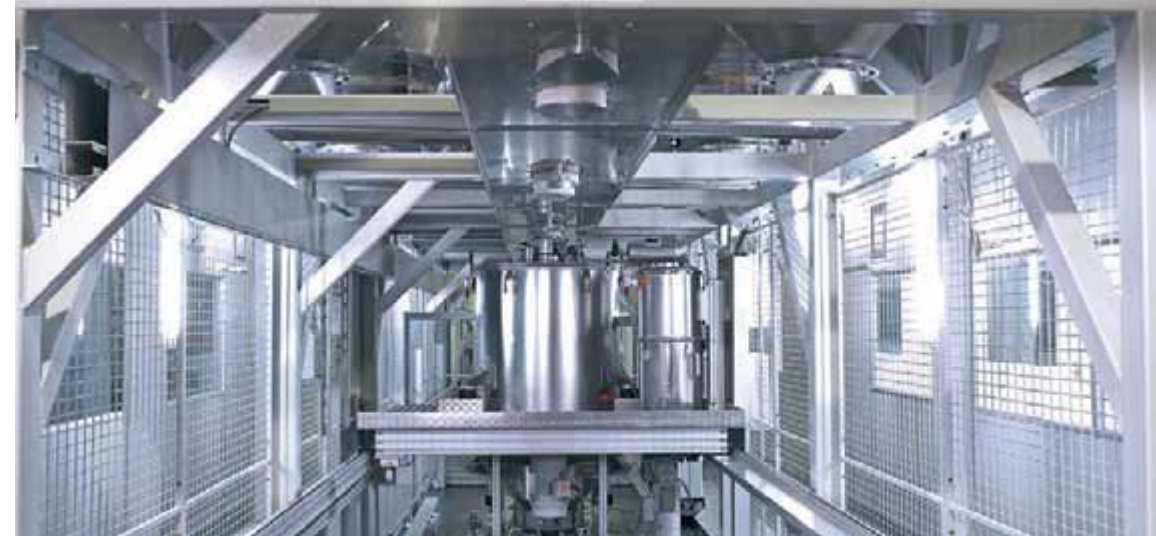
AZO COMPONENTER®, mit linear verfahrbarer Waage
