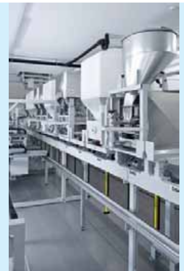
Im Vordergrund Mikro-Dosiermodul
