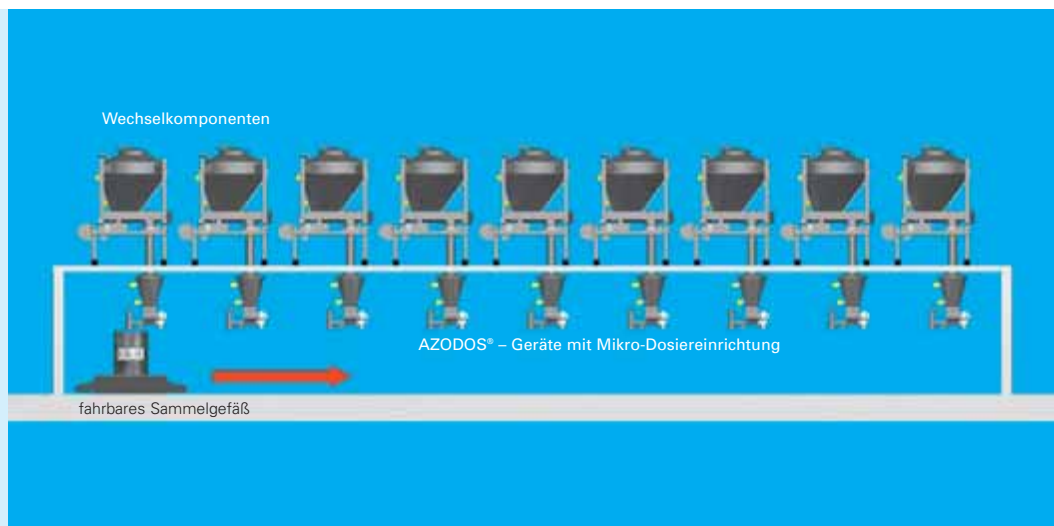
Kleinstmengen-Automatisierungssystem AZO® AutoDos mit Wechselkomponenten
