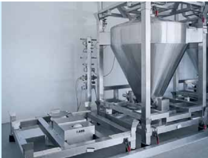
Aufgabestationen für AZO DOSITAINER® mit integriertem Antrieb
