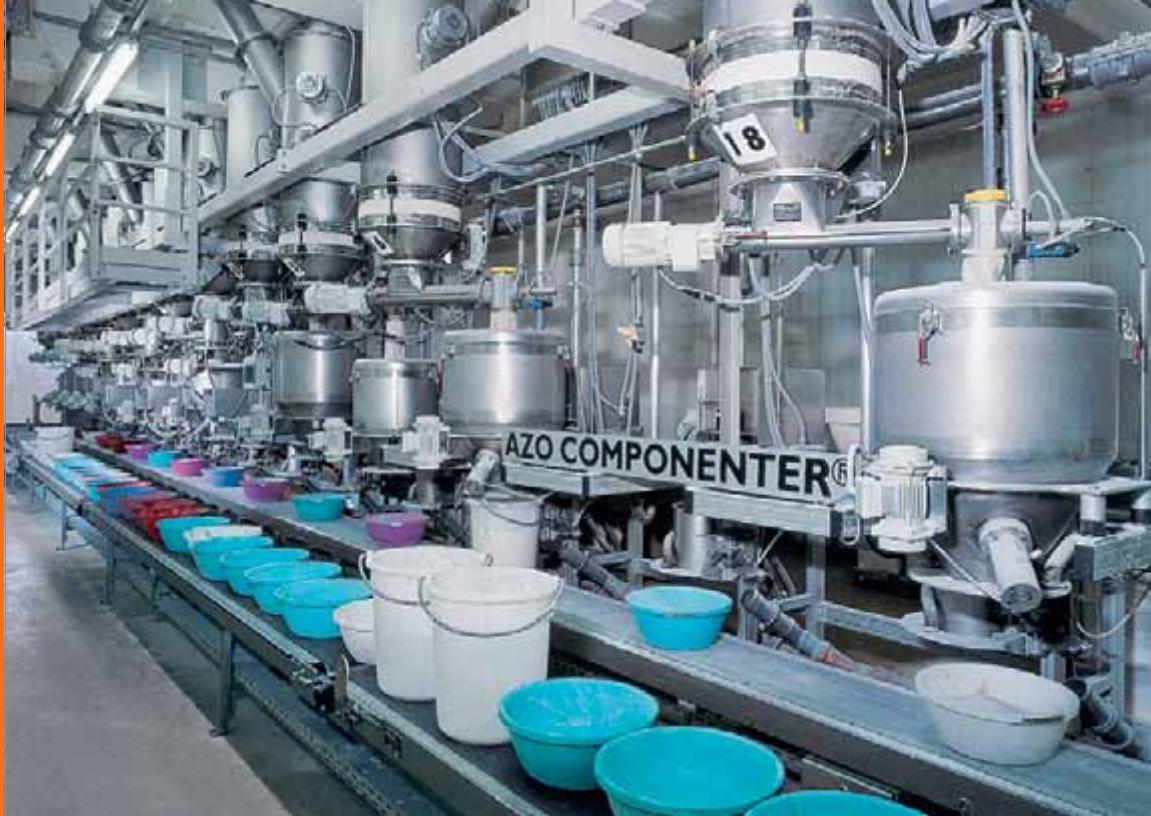
Hochgenaues Einwiegen in Gefäße
