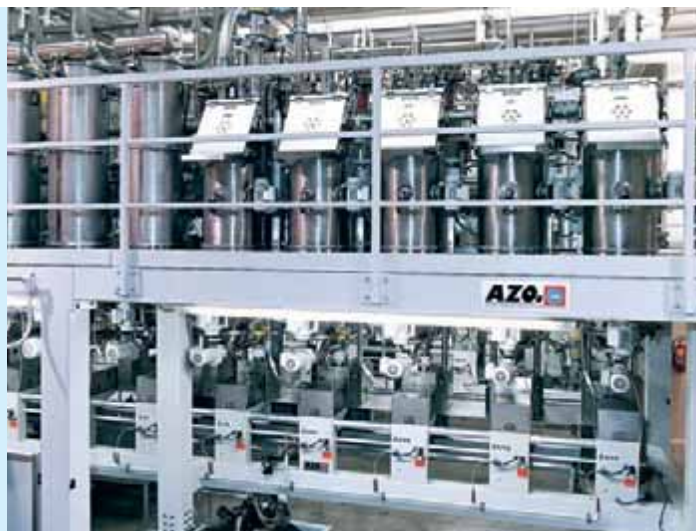
Einfülltrichter und Abscheider können als Vorratsbehälter eingesetzt werden
