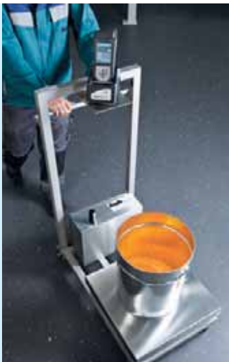
ManDos mobil: Höchste Flexibilität durch fahrbare Waage und mobiles Terminal mit WLAN-Anbindung
