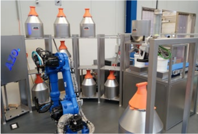
Der Roboter entnimmt die DLE mit der im Rezept vorgegebenen Komponente aus dem Rohstoff-Lager-Modul.
