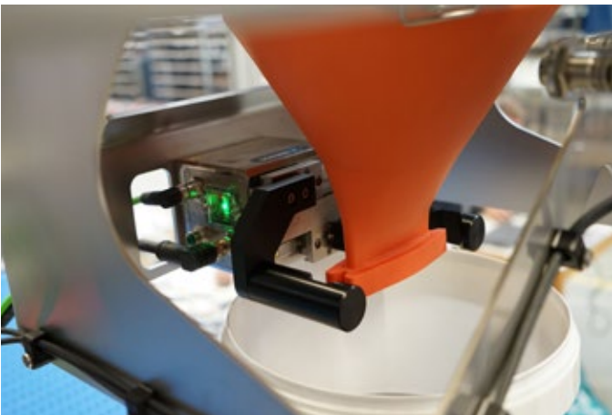
Über das Dosiersystem AZO®eDos erfolgt die grammgenaue Dosierung der Produkte in das Zielgebilde. Vorteile: Einfache Geometrie, gut zu reinigen, hygienisch, leicht zu demontieren
