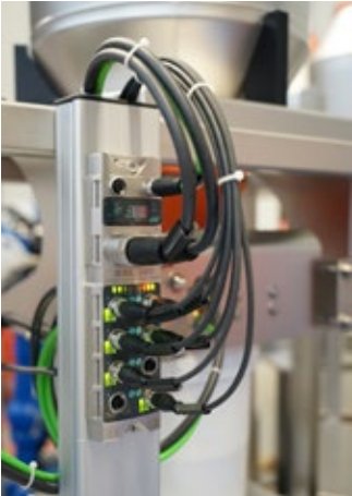
Kurze Montage- und Inbetriebnahmezeiten durch einfache Verkabelung mit IO-Link.
