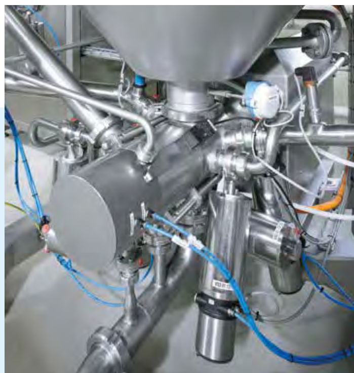
Homogenisator mit Pumpmodus ermöglicht das zerstörungsfreie Einmischen stückiger Güter ohne zusätzliche Pumpe
