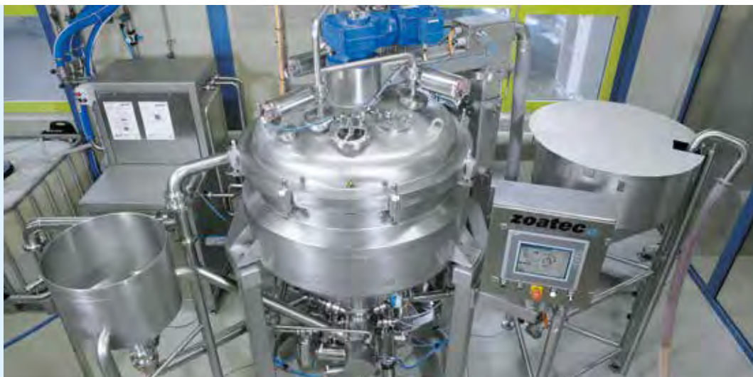
Die Trennung von Prozess- und Versorgungsmodul bietet klare Vorteile bei der Reinigung und den Aufstellungsmöglichkeiten
