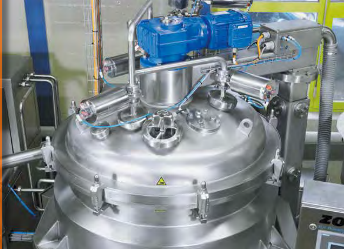
Behälterdeckel mit elektrischer Hubvorrichtung
