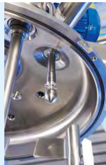
Sprühdüsen für eine rückstandsfreie CIP Reinigung
