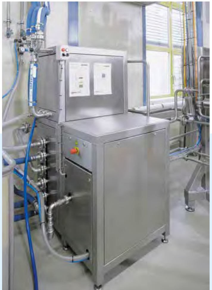
Separates Versorgungsmodul mit Pneumatik- und Vakuumeinheit sowie Flüssigkeitszählern
